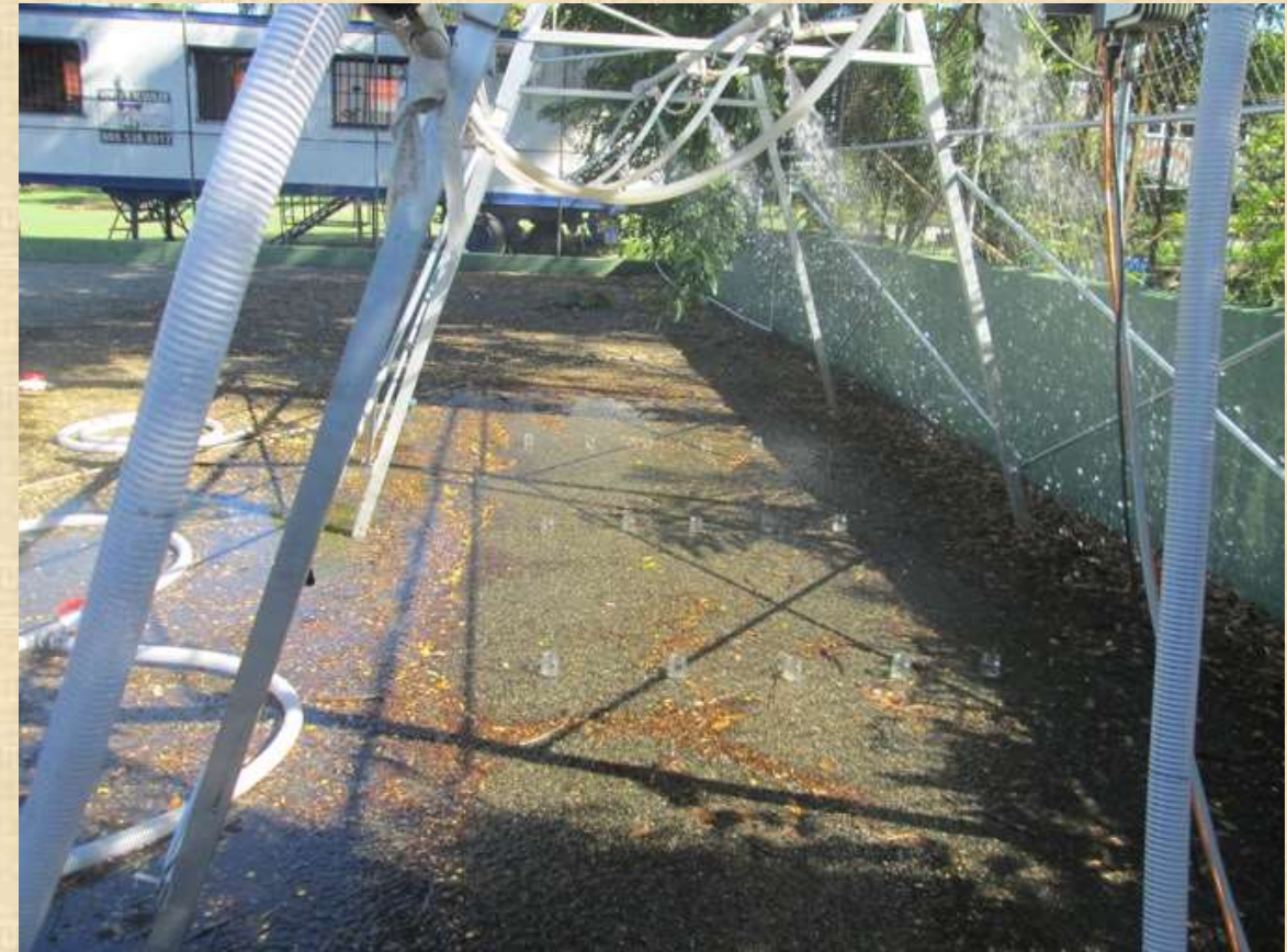
Colectando la lluvia para calcular la cantidad (precipitación equivalente), UNPHU, Octubre 1, 2021
